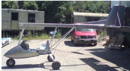
Окончательный вид конструкции балки и пилотской кабины
