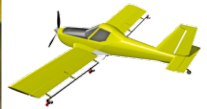
Система распыления самолета «Аграр»
