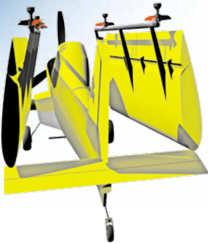
Для удобства транспортировки и хранения крылья «Аграр» легко складываются
